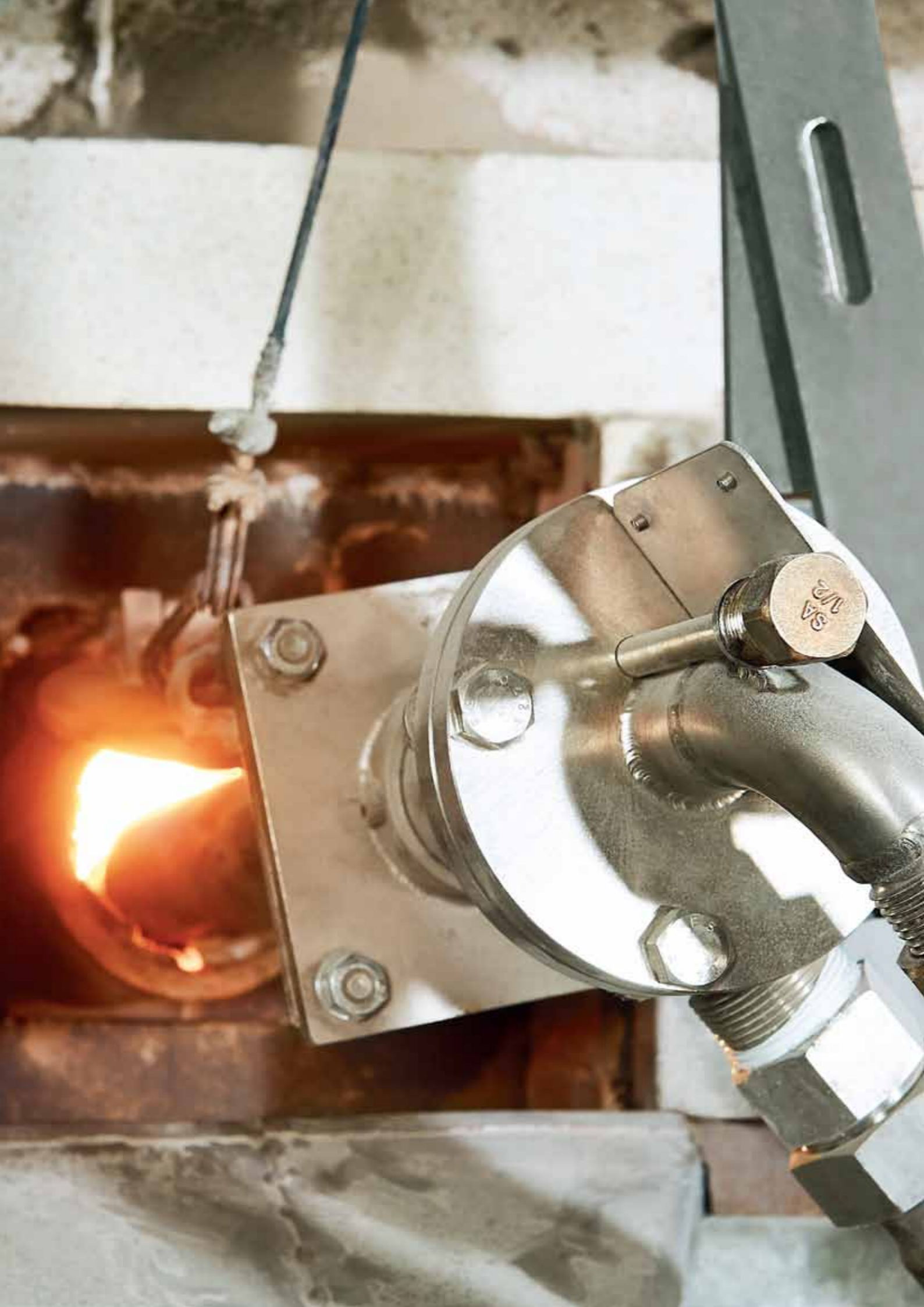
图1：氧燃料燃烧，减少氮气含量
